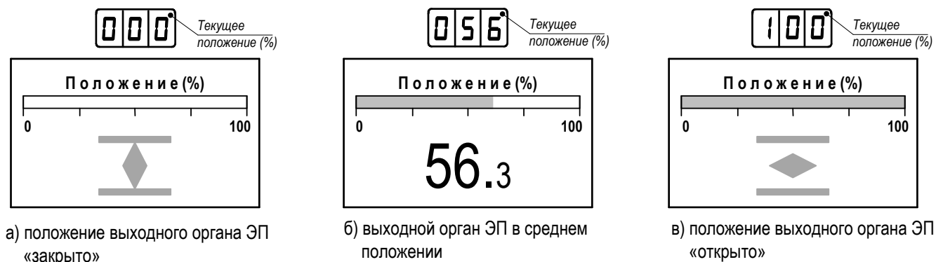
Рисунок 3 – Графический вид дисплея и цифровой индикатор. Информация о положении
