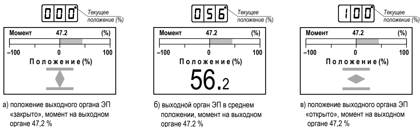
Рисунок 4 – Графический вид дисплея и цифровой индикатор. Информация о положении и моменте
